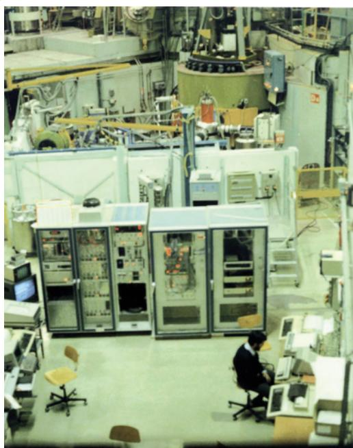
Experimento de difracción en el instrumento D4 en enero de 1987. Al fondo se observa el difractómetro, que cuenta con un criostato vertical naranja, capaz de bajar rutinariamente hasta 1,5 Kelvin. *Diffraction experiment on the D4 instrument in January 1987. The diffractometer is visible in the background. It has a vertical orange cryostat that is capable of routinely lowering temperature to 1.5 Kelvin.*
