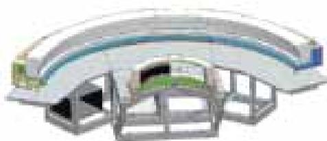
Resulta difícil para los no especializados entender las características y prestaciones de los instrumentos D1B y el D15, pero Campo explica de manera sencilla el funcionamiento de un instrumento de dispersión de neutrones. «En el experimento, el haz de neutrones impacta con la muestra a estudiar y se dispersa. Obtenemos información contando cuántos neutrones han sido dispersados en cada dirección y con qué energía».
